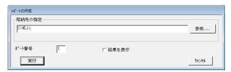
ライセンス取得情報ファイルの格納先の初期値は、ツールを起動したフォルダーと同じフォルダーになります。 他のフォルダーに格納したい場合は、参照... ボタンにより任意のフォルダーを指定し直してください。
